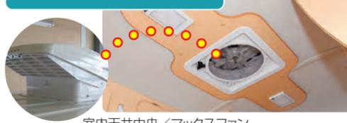
室内天井中央/マックスファン(吸・排気・スピード切り替え機能付)埋め込みLED2個
