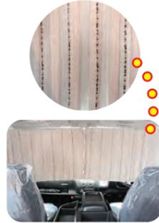
遮光カーテン式(プリーツ加工仕上げ)束ねた時にすっきり収納。フロントガラス部分までカーテンが閉まります。
