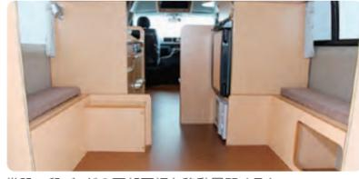
常設二段ベッドの下部天板を移動展開すると(幅1,200mm×奥行800mm)大容量収納庫になります。上部天板も脱着式になっています。
