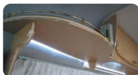
ギャレー上部LEDドームライト・間接照明・ライン付曲線デザインルーフ収納棚
