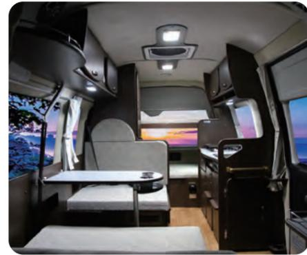
室内中央にダイネットとキッチン、開放的にダイネットは対面対座で4人掛け、後方に常設2段ベッドor収納スペース。
