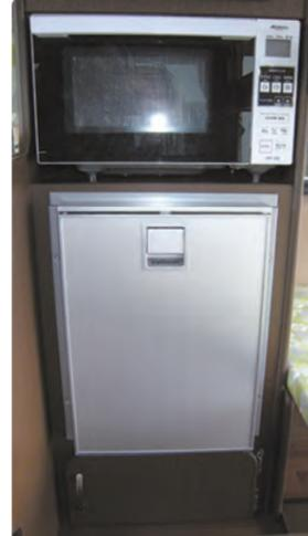
●上段AC100V用電子レンジ(600W)(インバーターから電源供給して使用できます)
