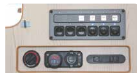
和室側/100Vコンセント 集中パネルスイッチ(ヒューズ付) FFヒータースイッチ USBソケット/ サブバッテリーデジタル残量計
