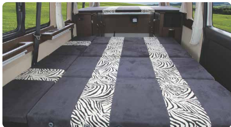
セカンド・サードシートフルフラットでベッドスペース(全長1,850×全幅1,550)
