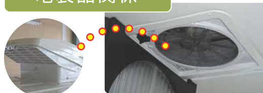
室内天井にマックスファン (吸・排気・スピード切り替え機能付)
