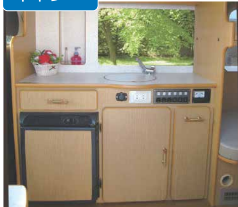
実用性を重視したギャレー (高690mm×幅1,030mm×奥500mm)
