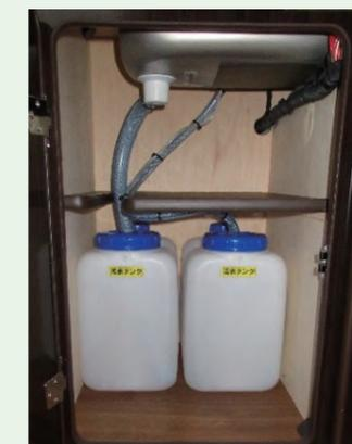
スライドドアを開けると、左側に傘立てと手すりの付いた靴入れが有り、中央には大きなスペース。そして奥には高さ690mm×幅1,030mm×奥行500mmのギャレーが有り、49ℓ冷蔵庫と10ℓ給水・排水タンク、収納及び電装スイッチが装備されています。
