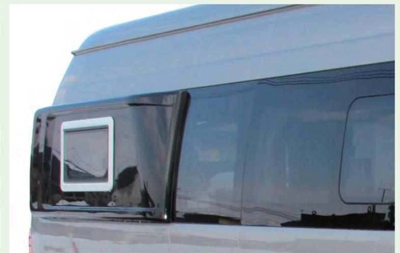
アウトパネルにアクリル窓（シェード・網戸付）が装着されているので車両後方の換気もスムーズ。
