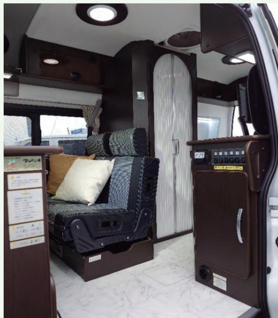
運転席を倒すと向かい合わせになるダイネット。中央部にはマルチルーム、ギャレー部には1口コンロ付きシンク、上部には収納、下部には49ℓ冷蔵庫と16ℓの給水・排水タンク、電装類スイッチを配置!
