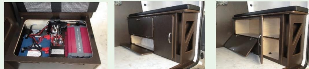
電装類をサードシート下に納めたので後方の常設ベッド下は全て収納として利用可能。
