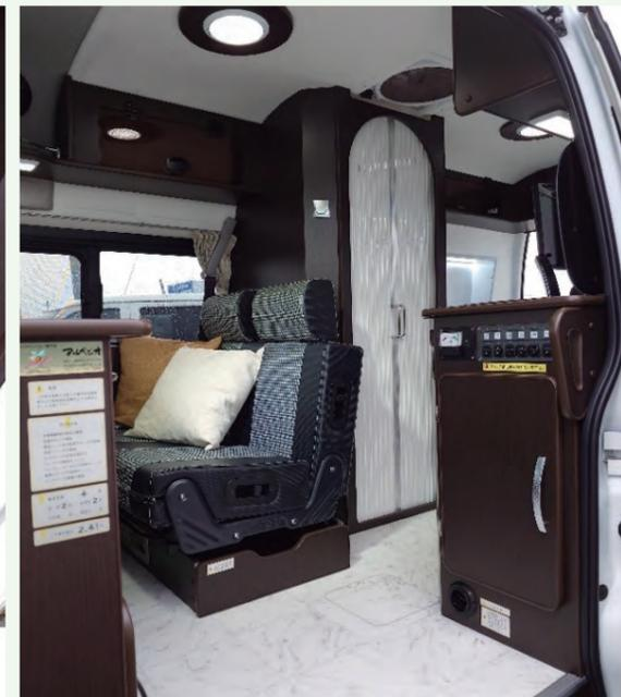
運転席を倒すと向かい合わせになるダイネット。中央部にはマルチルーム、ギャレー部には1口コンロ付きシンク、上部には収納、下部には49ℓ冷蔵庫と16ℓの給水・排水タンク、電装類スイッチを配置!
