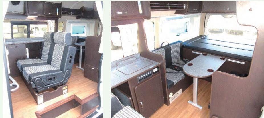
スライドドアを開けると前向き2人掛けセカンドシート。その後ろにはダイニングスペースがあり、セカンドシートを後ろ向きにセットすると3方向からテーブルを囲うレイアウトになります。横乗り座席の背もたれを広げるだけで長さ1,900mm×1,720mmのベッドが完成します！
