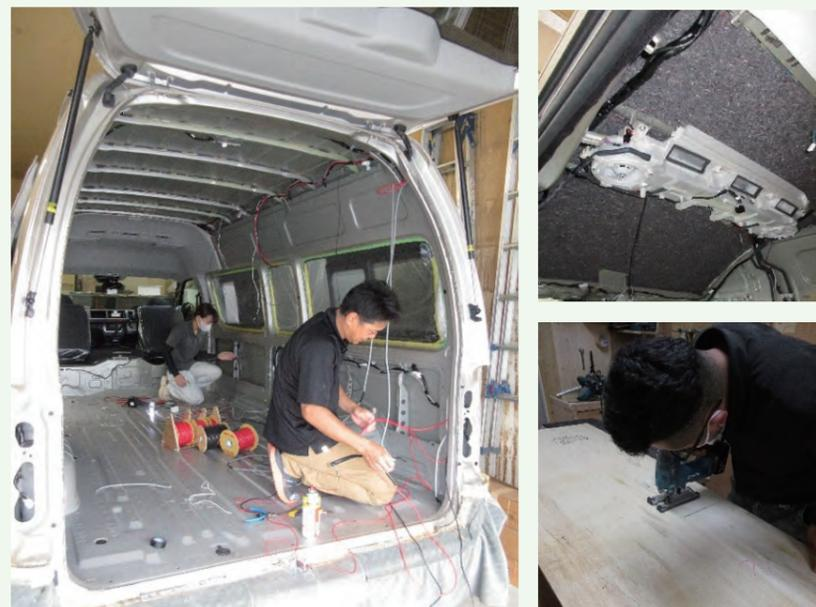
アルペジオ製作のキャンピングカーのメイン車両はトヨタハイエース・キャンパー専用車。元々ほぼ空の車両を更に分解、養生し、ベースとなる配線、断熱などの作業を行います。車両はオーダーを頂いてから1台1台丁寧に制作しています。
