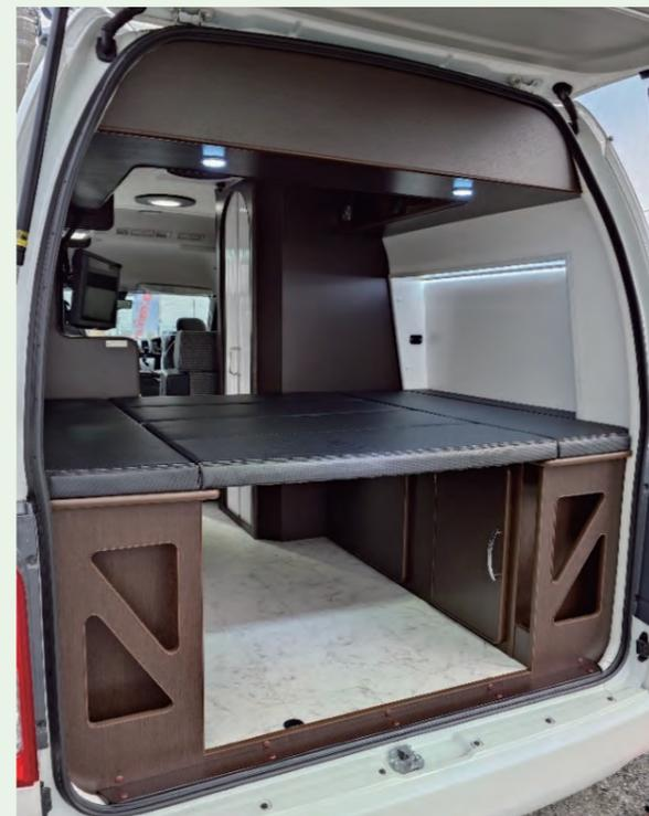
全長1,850mm×幅1,360mmサイズのベッドラインライトとUSBも装備。下には、幅900mm×奥行き1,320mm×高さ620mmのラゲッジスペース
