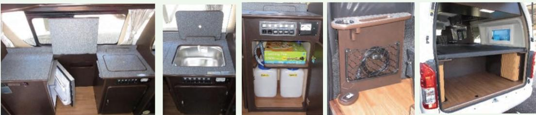
大容量のラゲッジスペース。両サイドにスライド扉式の収納を完備。幅1,230mm×奥行1,000mm×高さ600mm 天板を外すと高さ1,200mm
