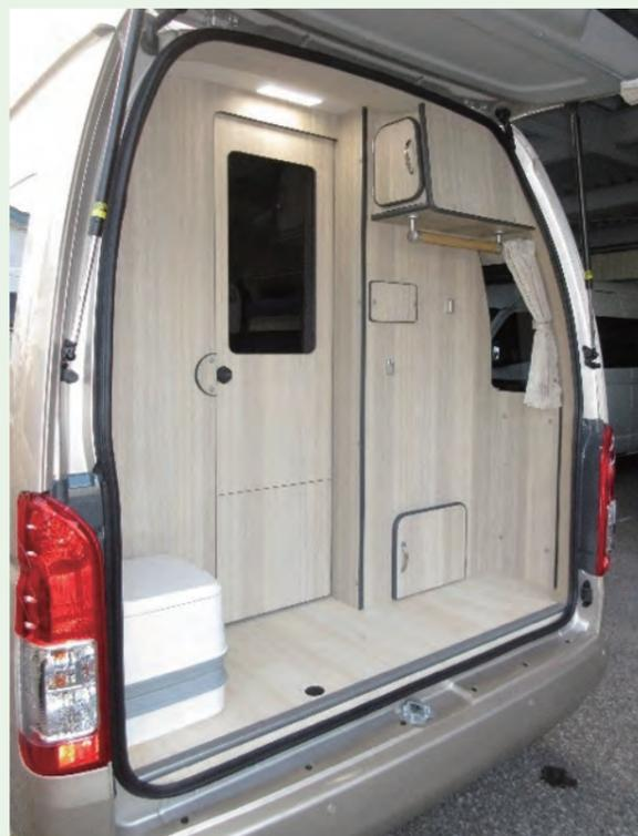
バックドアを開けるとハイエースのバンコンでは最大級のマルチルームが姿を現します。左側にポータブルトイレ（脱着式）、中央には車内とを行き来する為の扉、右側上部には小型ながら収納とハンガーラック、下部には収納の扉が付きます。
