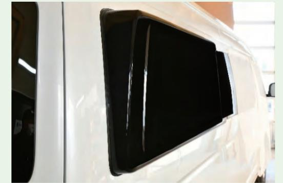
アウトパネルを採用する事で大人2人が横向きに就寝可能な常設ベッドが設定可能になりました。天板は2種類の硬さの異なるウレタンを無駄な厚みを出さず、硬過ぎず柔らか過ぎない適度な寝心地に成るように組み合わせて製作。キャンピングカービルダーならではのこだわりです。ベッドスペース上部にはコの字型の収納を設置、ベッド下部は大きな収納と大きな荷物置きスペースが有りクーラーボックスやキャンプ用品を積み込む事も出来ます。又普段使い時に天板を外せば自転車や長物なども積み込めるようになります。
