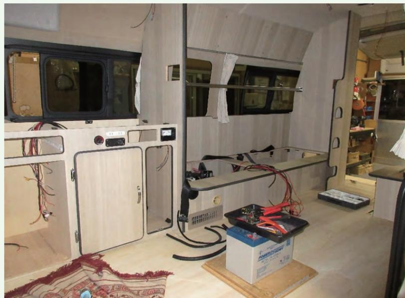
アルペジオの家具はメラミン化粧板材を貼り付けています。手間がかかるのですが、表面硬度が高く、耐汚染性、耐摩耗性、耐熱性、耐水性に優れ汚れや傷付きにくいので、多少汚れたり水で濡れてしまっても簡単にふき取る事が可能になります。せっかくのキャンピングカーを長く良い状態で使って頂きたいという想いを込めて最適な材料を選択しています。
