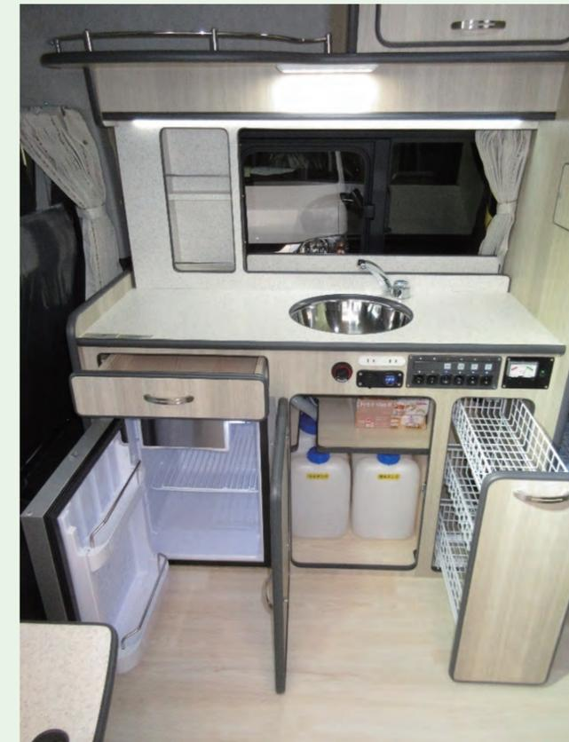
ギャレの天板には丸形シンク（蓋付き）、下部には49ℓ冷蔵庫、給排水タンク10ℓ×2、右側には引き出し式3段収納。電装類のスイッチ、USB、バッテリー残量計が集約されています。（※写真車両にはオプションのベバスト社製FFヒーターが装着されています。）
