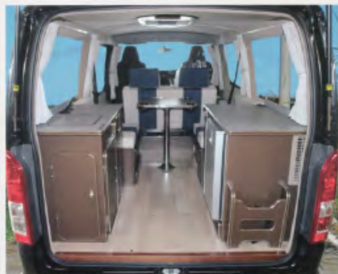
㊦ギャレー給排水タンク(各10ℓ)／㊦冷蔵庫(49ℓ)キャビネット
