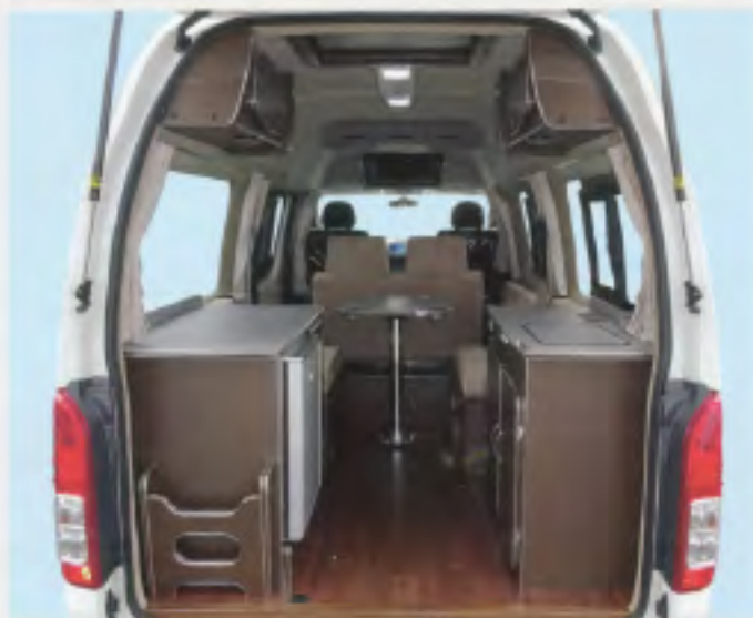
㊦冷蔵庫(49ℓ)／㊦ギャレー給排水タンク(各10ℓ)キャビネット
