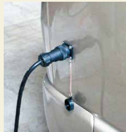
○外部防水100Vコンセント (3mケーブル・1,500Wまで対応)
